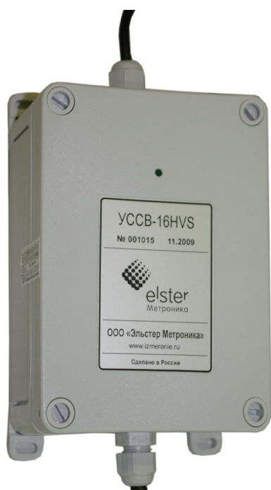
Обозначение приемника: YCCB-16HVS (выполнен на основе GPS 16HVS)
