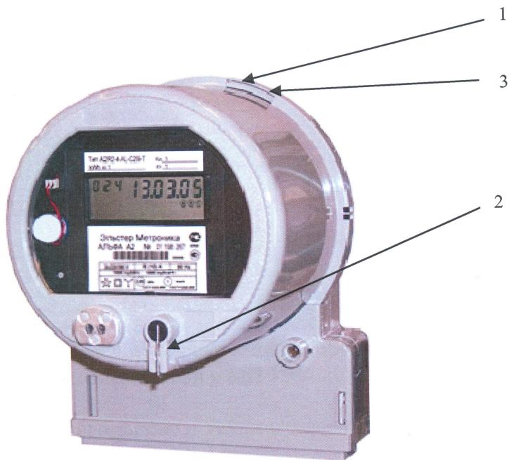
1 - пломба ОТК завода-изготовителя; 2 - пломба кнопки "RESET";
