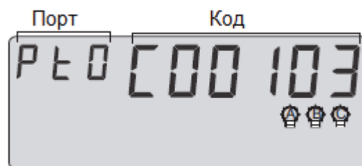
Рисунок 5.12 – Пример отображения коммуникационного кода “C00103”
