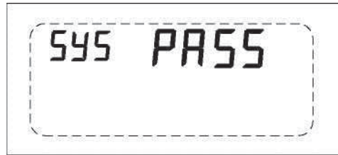
Рисунок 5.8 Отображение успешно проведенного теста тока.
