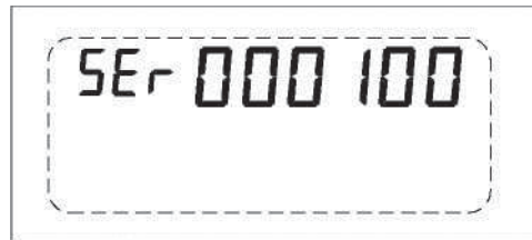
Рисунок 5.9 Отображение кода ошибки теста тока сети
