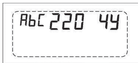
Рисунок 5.6 Отображение типа сети номиналом 3х220/380В
