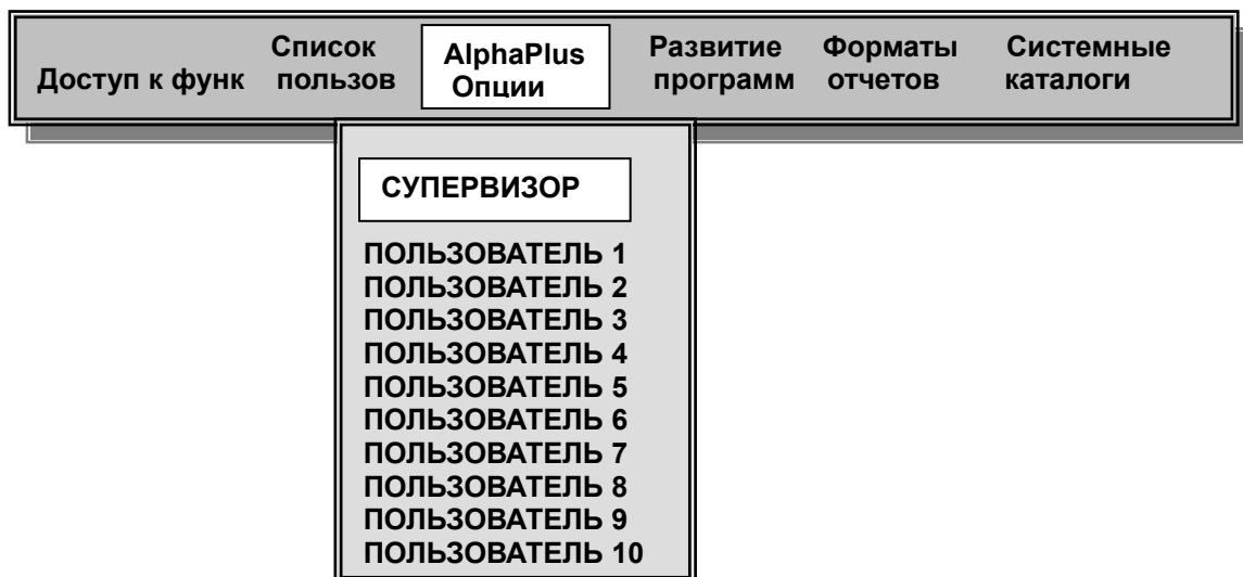
Эта часть программы SETUP конфигурирует выполнение функций чтения счетчика, модификации и замены программы в счетчике, определяет опции программы, связи, модема для каждого пользователя в том числе и для главного пользователя – **СУПЕРВИЗОРА**. Выбрав определенного пользователя нажмите **ENTER**. В верхней части экрана появится меню, приведенное ниже.
