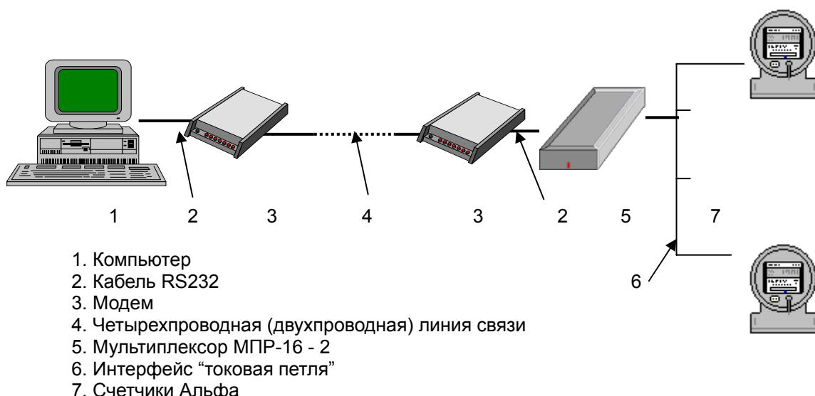
Длина кабеля “токовая петля” не должна превышать 500 метров, кабеля интерфейса RS232 15 метров.
