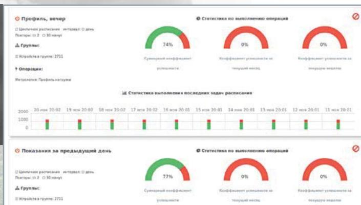
Контроль монтажа оборудования в реальном времени: автоматическое обнаружение и добавление в БД смонтированных УСПД и счетчиков. Устранение ошибок вызванных человеческим фактором + экономия времени на наладку.
