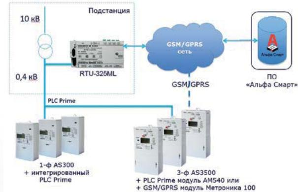
**Конфигурирование** устройства учета энергоресурсов, используя различные протоколы передачи конфигурационных данных:
