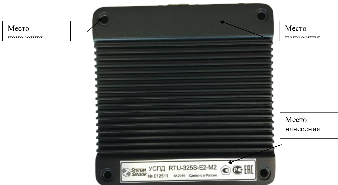
Рисунок 1 – Общий вид УСПД с указанием мест нанесения знака утверждения типа, знака поверки и заводских стикеров
